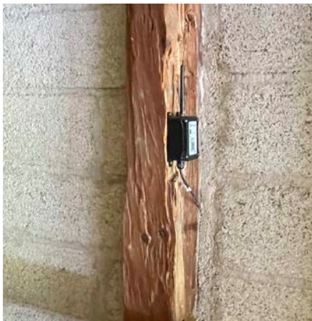
Hanfsteinwand unverputzt mit Feuchtesensoren
